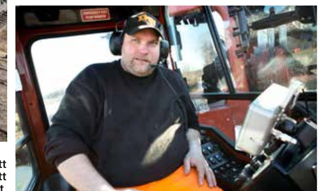
Med det här instrumentet håller Hans Karlsson hela tiden koll på vad borrarpeten befinner sig. Behövs det riktningförändringar rapporterar han till kollegan Fredric Persson som manövrerar riggen.
