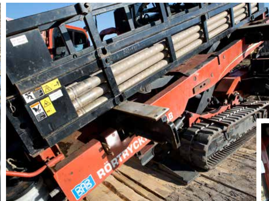
Varje borrstång mäter 4,5 meter. Man plockar på nya allt eftersom arbetet fortskrider.
