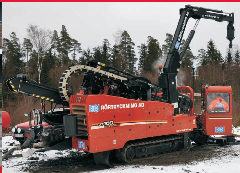
Vid de fall där vi har längre AT-borrningar har vi även tagit in vår DW AT100 som är nordens största rigg för styrd AT-borrning.
